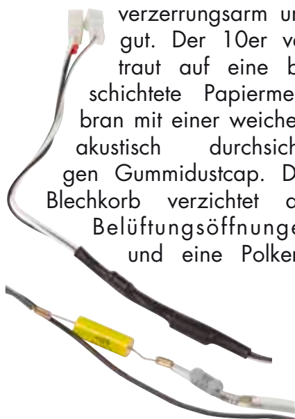
Im Anschlusskabel des Hochtöners verstecken sich ein Folienkondensator und ein Widerstand
