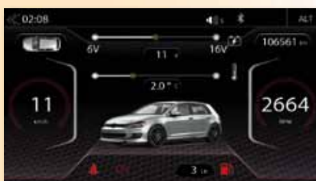
Über den CAN-Bus können Fahrzeugparameter angezeigt werden
